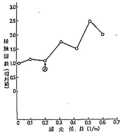
図3 安定度検査器で測定された接触回数および心拍数の変化。④は本文参照のこと。
