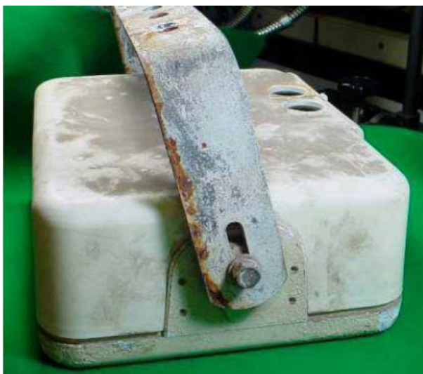
屋内用器具を雨がかかる場所に設置
