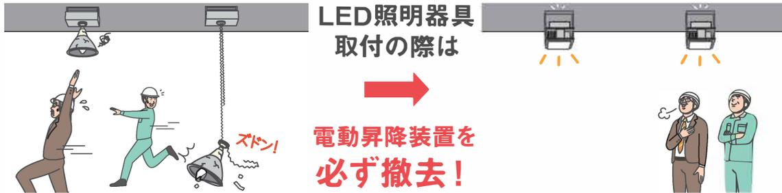
昇降装置には耐用の限度があり、設置して8年～10年を経過したり昇降回数が増すと、外観に異常がなくても内部の劣化は進行しています。設置から15年以上経過している場合は、落下につながる可能性もございますので、必ず昇降装置を撤去の上、新しい器具への交換をお願いします。
